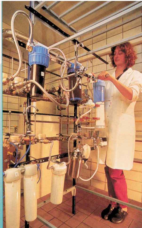
Hänge-Partie: Im Versuchsraum sind die acht Probanden neben- und untereinander aufgebaut. Jeder Filter hat eine eigene Wasseruhr. Der Betriebsdruck ist für alle gleich.
