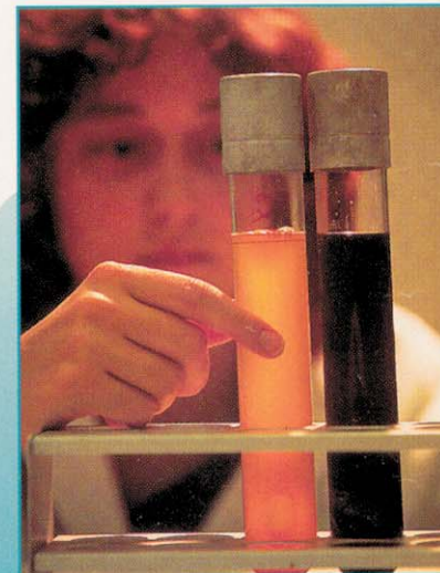
Nährlösung und 100 Milliliter Wasser färben sich blau. Verändert sich die Probe unter Gasung gelblich, besteht Verdacht auf E-Coli.
